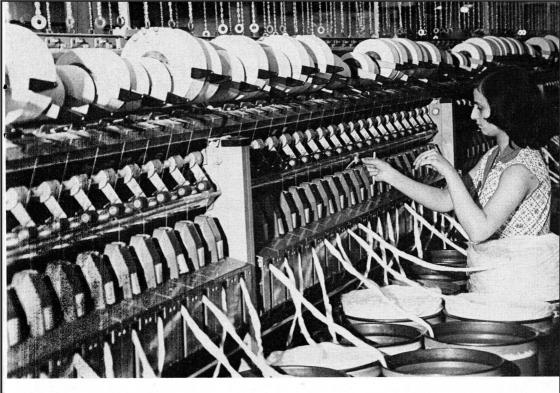
Die Rotor-Spinnmaschine formt aus dem vorgelegten Streckenband ein gedrehtes Garn und wickelt dieses auf Spulen von ca. 2 kg.
